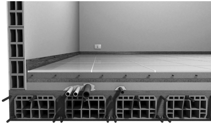
Figura 1 Il pavimento galleggiante
